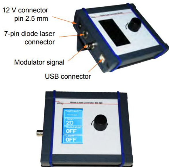
Рис. 2.8. Модуль Н – цифровой контроллер лазерных диодов и элементов Пельтье ED-020
